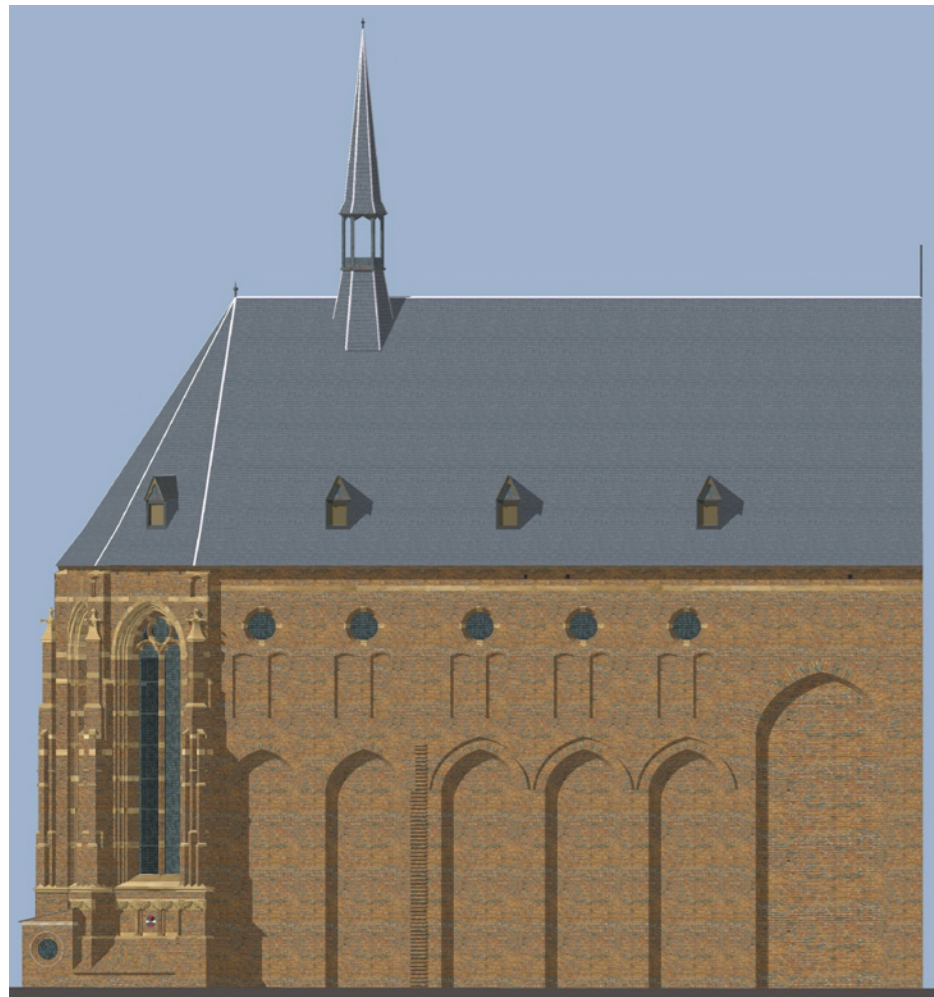
7.10 | Reconstructie van de noordgevel van de kloosterkerk rond 1500. Zichtbaar is de reeks ronde vensters in de lichtbeuk, de blindnissen daaronder en de voorlopig dichtgemetselde scheibogen ter voorbereiding van de bouw van de zijbeuk.
